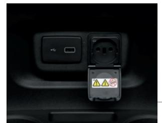
La presa di alimentazione da 230 V aiuta a caricare facilmente dispositivi elettrici come laptop, batterie di utensili elettrici, tablet, smartphone e altre apparecchiature a bassa potenza che necessitano di elettricità fino a 150 Watt.
