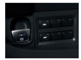
Il nuovo freno di stazionamento elettrico offre un maggiore comfort nell'uso quotidiano. Il conducente può attivare il sistema di bloccaggio tramite un interruttore dedicato situato sulla plancia; la funzionalità può anche essere abilitata automaticamente tramite un'impostazione specifica del quadro strumenti.
